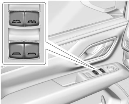
Электрические стеклоподъемники работают при включенном зажигании, в режиме питания вспомогательного оборудования, а также в режиме задержки отключения питания дополнительного оборудования.
