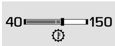
Эти показания выводятся, когда автомобиль находится в буксировочном/транспортировочном (Tow/Haul) ходовом режиме, и щиток настроен на отображение четырех нижних приборов. Показания температуры масла КПП можно также настроить на вывод в информационной области слева или справа. Порядок изменения конфигурации приборов см. в параграфе «Параметры» раздела Комбинация приборов (Расширенная комплектация) ↻ 4-14 или Комбинация приборов (Базовая комплектация) ↻ 4-11.
