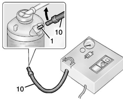
4. Присоедините воздушный шланг (10) к впускному клапану баллона с герметиком (1) и плотно заверните по часовой стрелке.
