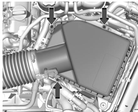
1. Выверните три винта, наклоните крышку и отсоедините ее от корпуса.
