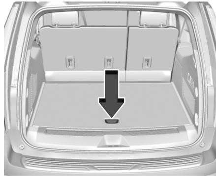
В полу заднего багажного отделения также имеется место для хранения. Поднимите рукоятку, чтобы получить к нему доступ.
