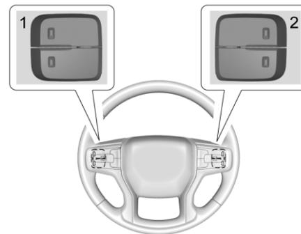
Клавиши переключения избранного и регулировки громкости расположены с тыльной стороны рулевого колеса.
