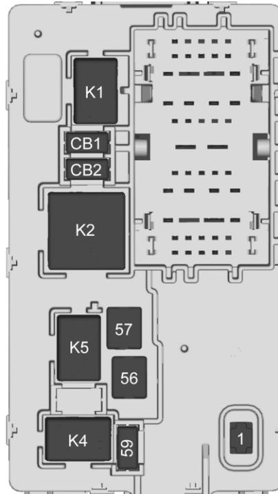
На задней стенке блока предохранителей находятся реле. Для получения доступа нажмите на лепестки и снимите блок предохранителей.
