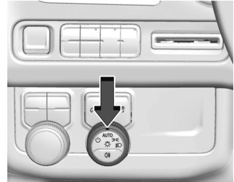
Задние противотуманные фонари улучшают видимость автомобиля сзади в условиях тумана или измороси.
