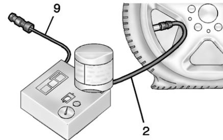
7. Наденьте шланг для воздуха и герметика (2) на вентиль шины и плотно наворачите его по часовой стрелке.
