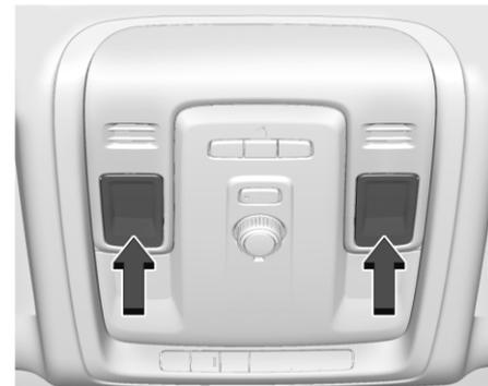
Кнопки управления передними плафонами для чтения расположены на верхней консоли. Чтобы включить или выключить передние плафоны для чтения, нажмите на них.
