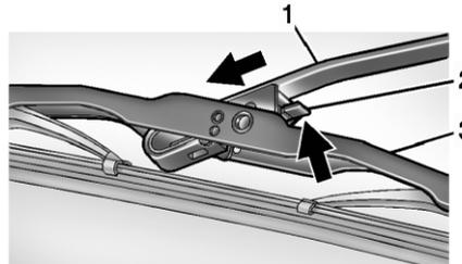
2. Надавите на рычаг отсоединения (2), чтобы отсоединить крючок, и вытолкните рычаг стеклоочистителя (1) из щетки в сборе (3).
