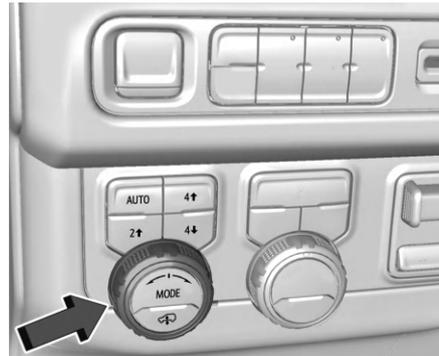
Чтобы перейти в любой из режимов, поверните ручку Mode (режим), расположенную на щитке приборов слева от рулевого колеса.
