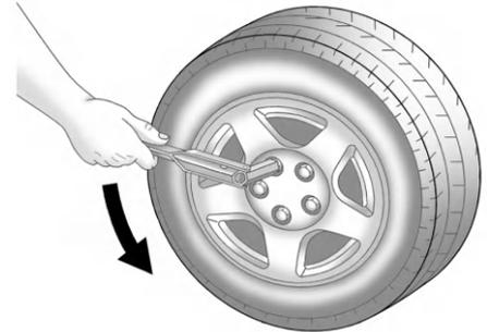
3. С помощью колесного ключа ослабьте все гайки крепления колеса. Вращая колесный ключ против часовой стрелки, ослабьте гайки крепления колеса. Не скручивайте гайки полностью.
