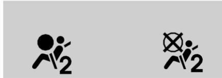
При запуске автомобиля в ходе проверки системы индикатор состояния подушки безопасности пассажира попеременно включает на несколько секунд символы включенной и отключенной подушки.
