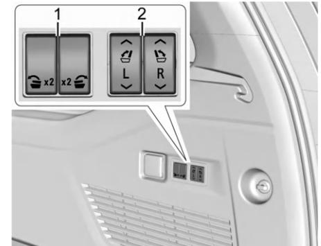
1. Переключатели складывания и опрокидывания сидений второго ряда с электродвигателем
