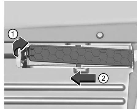
4. Потянув за рычажок (1) слева от крышки фильтра, сдвиньте его влево (2), после чего снимите крышку. Снимите прежний фильтр.
