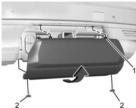
Чтобы снять крышку тягово-сцепного устройства (при его наличии):
