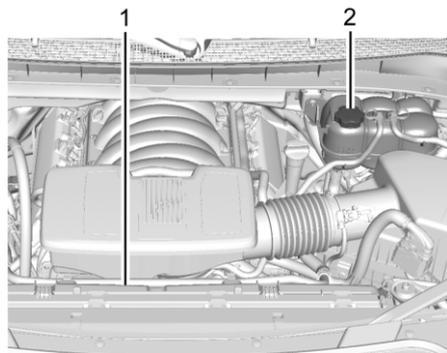
1. Электрические вентиляторы охлаждения двигателя
