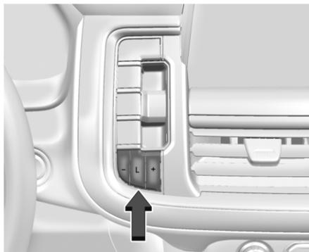
В ручном режиме и в режиме ERS можно выбирать диапазон передач самостоятельно. Используйте этот режим при движении вниз по склону или при буксировке прицепа для ограничения максимальной передачи и скорости автомобиля.
