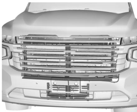
Автомобиль может быть оснащен жалюзи радиатора, которые повышают эффективность расхода топлива. Очищайте жалюзи радиатора от мусора, снега и льда. Если загорелась сигнальная лампа проверки двигателя, проверьте отсутствие мусора, снега или льда в жалюзи радиатора.
