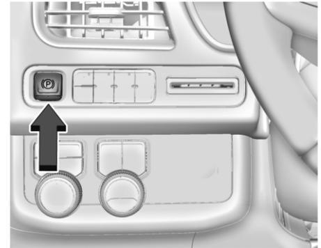
Электромеханический стояночный тормоз (EPB) можно привести в действие даже при отключенном зажигании. При нехватке мощности электропитания тормоз EPB нельзя ни привести в действие, ни отпустить. Старайтесь не включать электромеханический стояночный тормоз много раз подряд без необходимости, чтобы не разрядить аккумулятор.
