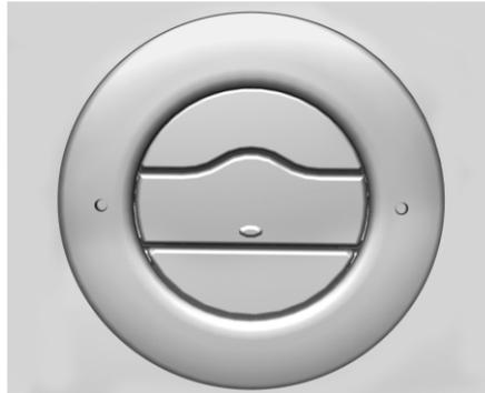
Чтобы открыть круглое выпускное отверстие, нажмите на задний край средней пластины. За среднюю пластину отверстие можно вращать, меняя направление воздушотока. Чтобы перекрыть воздушоток, нажмите на передний край средней пластины.
