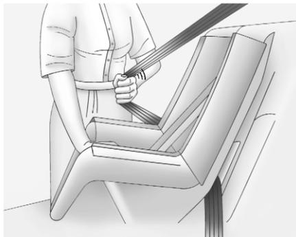
5. Полностью вытяните плечевую ветвь ремня безопасности из инерционной катушки до срабатывания храпового механизма. После того как сработает храповик инерционной катушки, ремень можно будет подтягивать, но не ослаблять.
