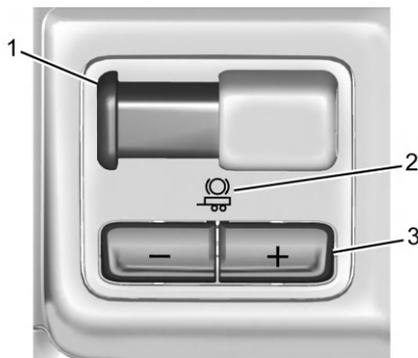
1. Рычаг приведения тормозов прицепа в действие вручную
