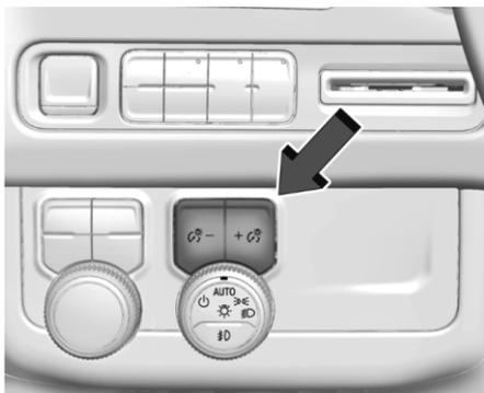
Данная функция позволяет настроить яркость подсветки органов управления. Управление подсветкой приборной панели над выключателем наружного освещения.
