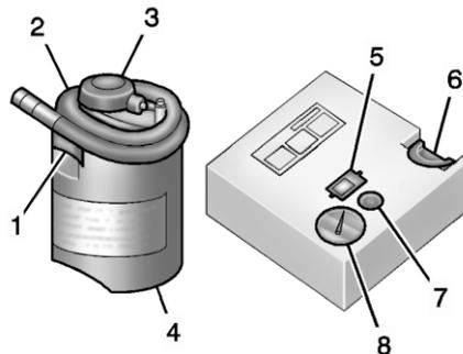
1. Впускной клапан баллона с герметиком
