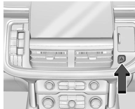
⚠ :Нажатие этой клавиши включает передние и задние указатели поворота в проблесковом режиме. Нажмите снова, чтобы выключить световую сигнализацию. Если включена аварийная световая сигнализация, указатели поворота не работают.
