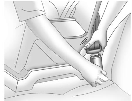
3. Введите язычок в замок, чтобы он зафиксировался со щелчком. Расположите кнопку освобождения ремня безопасности на пряжке в стороне от детского удерживающего устройства, чтобы при необходимости ремень безопасности можно было быстро отстегнуть. Доступ к кнопке разблокировки не должен закрываться детским удерживающим устройством. Детское удерживающее устройство не должно давить на кнопку.
