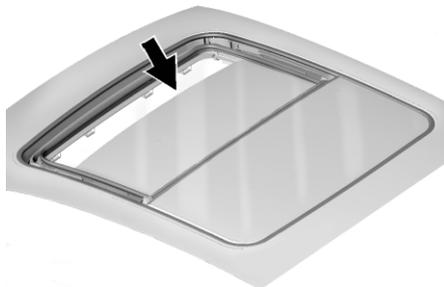
На уплотнителе и направляющих люка крыши может скапливаться пыль и грязь.
