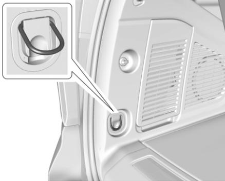
В заднем багажном отделении имеются две стяжки для крепления груза. Их можно использовать для привязывания груза, чтобы предотвратить его перемещение в автомобиле.
