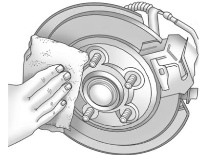
8. Удаляйте любую ржавчину или грязь с колесных болтов, монтажных поверхностей и с запасного колеса.
