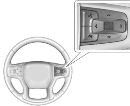
Используйте блок клавиш на правой спице рулевого колеса для перемещения по различным элементам меню дисплея.
