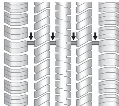
Необходимость замены старых шин новыми определяется только по признакам износа шин. Признаки износа появляются на шинах с остаточной глубиной протектора 1,6 мм (1/16 дюйма) или менее. Более подробная информация представлена в разделах Осмотр шин  $\diamond$  9-43 и Перестановка шин  $\diamond$  9-43.
