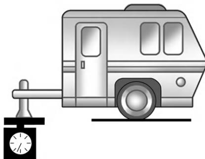
Для обычного тягово-сцепного устройства вертикальная нагрузка на ТСУ от прицепа не должна превышать 567 кг (1250 фунтов).
