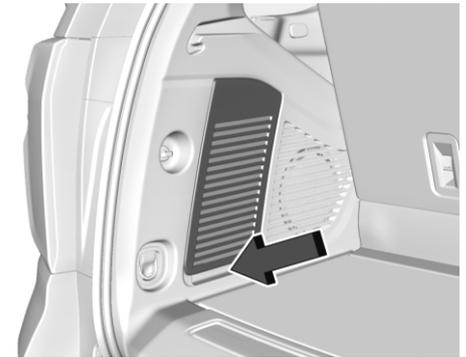
Блок предохранителей в багажном отделении находится под съемной панелью в левой части отделения. Вытяните панель, поддев ее пальцем сзади через выемку.
