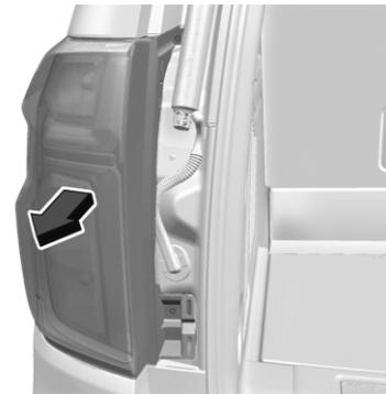
5. Сдвиньте назад задний фонарь в сборе, чтобы извлечь его из автомобиля.
