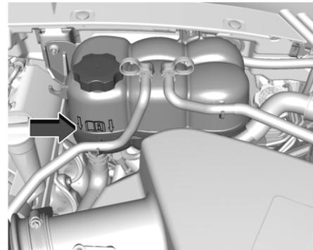
3. Залейте в расширительный бачок охлаждающую жидкость правильного состава до отметки полного холодного объема.
