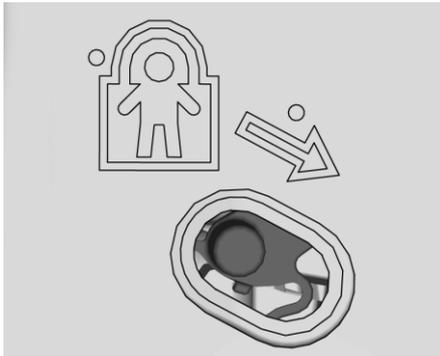
Предохранительный замок находится на внутренней кромке задних дверей.
