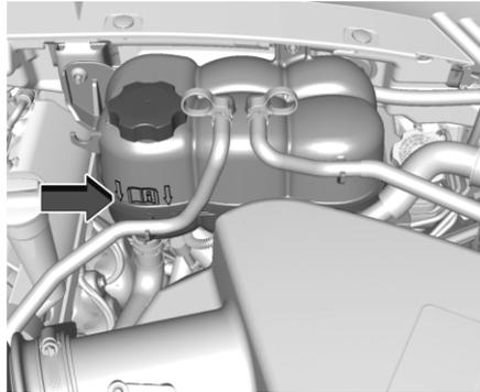
Визуально проверьте, имеется ли в расширительном бачке охлаждающая жидкость.
