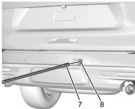
4. Вставьте свободный конец надставки (7) в отверстие в заднем бампере (8) (отверстие для доступа к валу подъемника). Проследите за тем, чтобы конец надставки со стороны подъемника (7) подсоединился к валу подъемника. Оребренный квадратный конец надставки служит для опускания запасного колеса.
