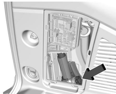
2. Поверните круглую ручку домкрата против часовой стрелки, чтобы освободить домкрат и противооткатные упоры из кронштейна. Извлеките противооткатные упоры (при наличии) из домкрата и установите их с обеих сторон колеса, расположенного по диагонали от того колеса, которое вы собираетесь менять.
