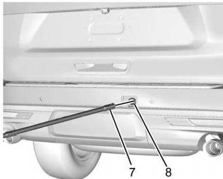
4. Вставьте свободный конец надставки (7) в отверстие в заднем бампере (8) (отверстие для доступа к валу подъемника).
