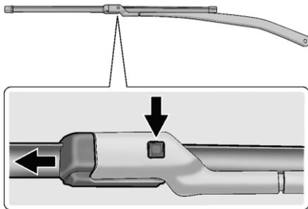
2. Нажмите на кнопку, находящуюся в центре соединителя рычага стеклоочистителя и выдерните щетку стеклоочистителя из соединителя рычага.
