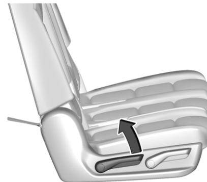
1. Поднимите рычаг на внешнем краю спинки.
