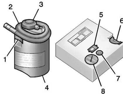
1. Впускной клапан баллона с герметиком
