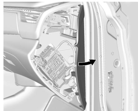
Крышка для доступа к правому блоку предохранителей в приборной панели находится в торце приборной панели со стороны пассажира.
