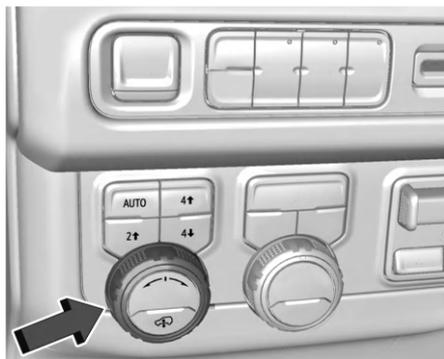
Если автомобиль оснащен раздаточной коробкой, то ее органы управления служат для включения и отключения привода на четыре колеса.
