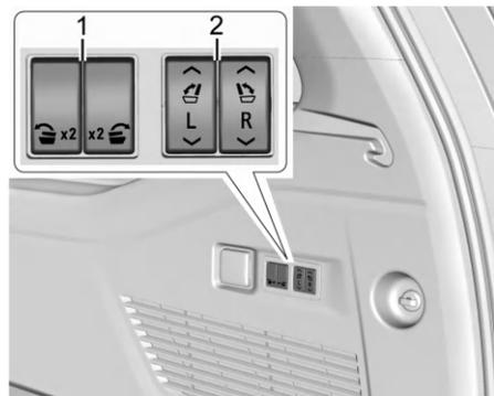
1. Переключатели складывания и опрокидывания сидений второго ряда с электродвигателем
