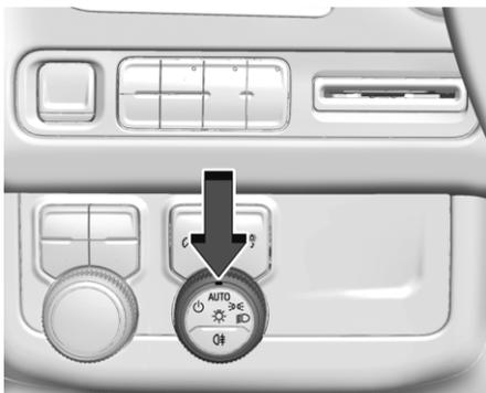
Выключатель наружного освещения расположен на приборной панели слева от рулевого колеса.
