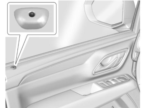
Расположенный на двери водителя рядом с окном индикатор показывает состояние системы: См. раздел Электроблокировка замков дверей ⇨ 1-11
