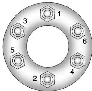
12. Крепко затяните гайки в перекрестной последовательности, как показано на иллюстрации, вращая колесный гаечный ключ по часовой стрелке.
