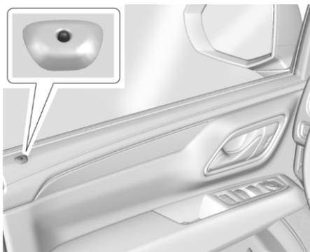
Световой индикатор на верхней поверхности панели двери водителя показывает состояние противоугонной системы автомобиля.
