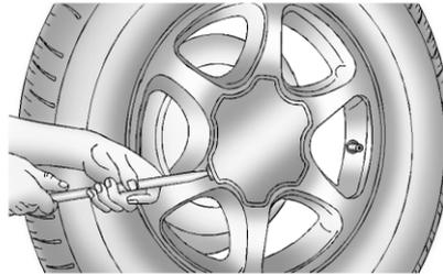
2. Если автомобиль оснащен центральным колпаком, закрывающим крепление диска, вставьте долотообразный конец колесного гаечного ключа в щель на диске и аккуратно извлеките колпак.
