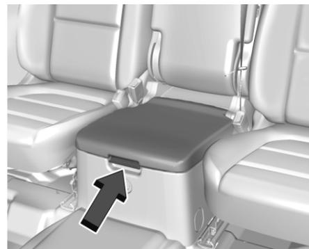
Если в автомобиле предусмотрен отсек для хранения в переднем центральном сиденье, он открывается механическим ключом, который находится внутри радиобрелока. См. Ключи ↻1-2. Чтобы открыть, нажмите на защелку и поднимите.
