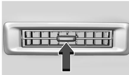
Направление воздушотока из прямоугольных вентиляционных отверстий меняется сдвигом ползунка, а перекрывается воздушоток вращением цилиндра влево или вправо.
