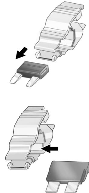
3. Используйте его для захвата предохранителя сверху или сбоку, как показано на иллюстрации выше.
