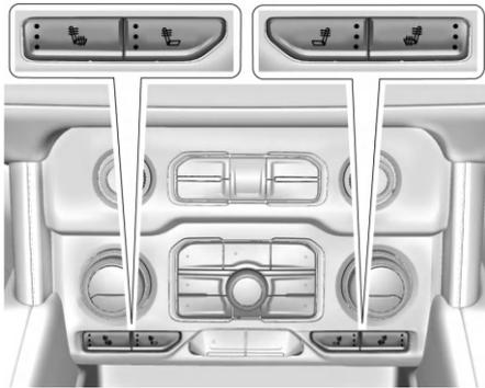
Кнопки (в соответствующей комплектации) находятся рядом с регуляторами системы климат-контроля на центральной стойке. Подогрев сидений работает только при включенном двигателе.
