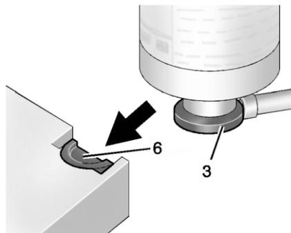
5. Вставьте основание баллона с герметиком (3) в вырез наверху компрессора (6), чтобы зафиксировать баллон в вертикальном положении.
