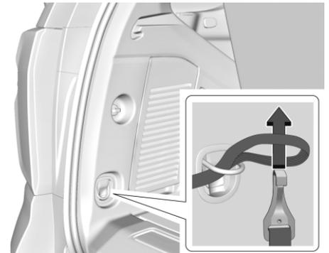
4. Извлеките крепежный ремень спустившего колеса из перчаточного ящика и вставьте петлю крепежного ремня в проушину. Проведите крюк ремня сквозь петлю и потяните за него так, чтобы ремень был надежно прикреплен к проушине.
