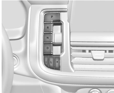
Переключатели передач находятся на центральной консоли. Выбранная передача обозначается встроенным в переключатель красным индикатором, а остальные индикаторы остаются белыми. Если переключение передач происходит с задержкой, например, при очень низкой температуре, то встроенный в переключатель индикатор может мигать, пока переключение передачи не завершится.
