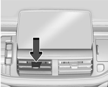
Чтобы изменить направление воздушотока, сдвиньте ползунок. Чтобы закрыть вентиляционное отверстие, переведите ползунок в крайнее от себя положение.
