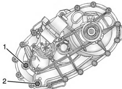
1. Пробка наливного отверстия
