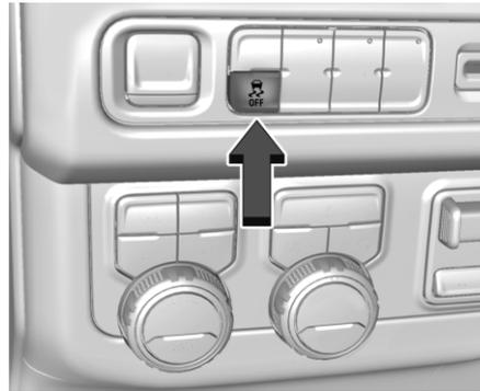
Кнопочный выключатель функций TCS и StabiliTrak/ESC находится на приборной панели слева от рулевого колеса.
