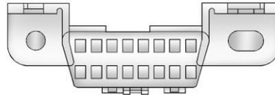
Разъем канала передачи данных расположен под приборной панелью слева от рулевого колеса. Подключение к этой колодке оборудования, не предназначенного для контроля токсичности во время техосмотра или для обслуживания автомобиля, может отразиться на работе автомобиля. См. Дополнительное электрооборудование ↻ 8-89. За помощью обратитесь к своему дилеру.
