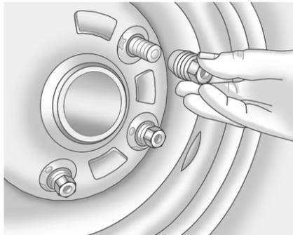
6. Отверните все колесные гайки.
