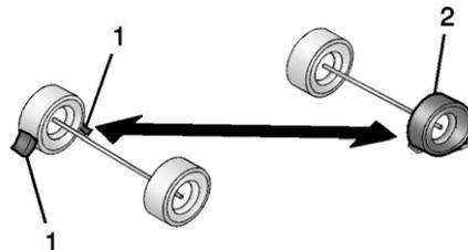
1. Противооткатный упор (в соответствующей комплектации)
