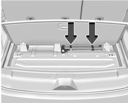
3. Поднимите грузовой пол. Извлеките подъемные инструменты и разместите их рядом с колесом, которое следует заменить.
